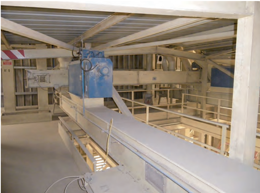
ILUSTRACIÓN 5. Aspiración localizada en transportador de cadena (Por cortesía de Nanta)
