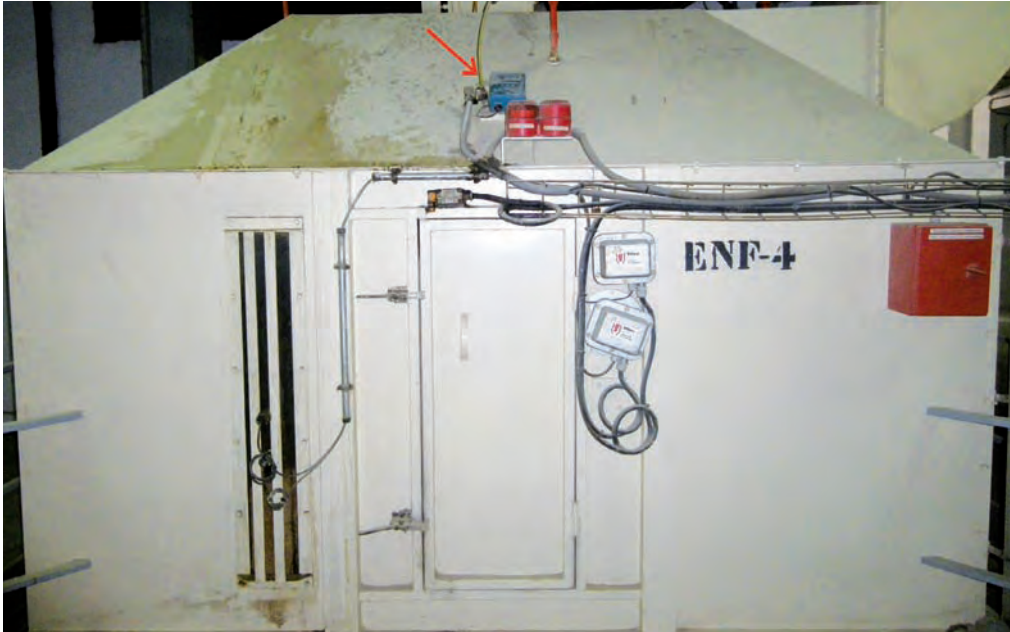
ILUSTRACIÓN 14. Equipo detección chispas en enfriador (Por cortesía de Nanta)
