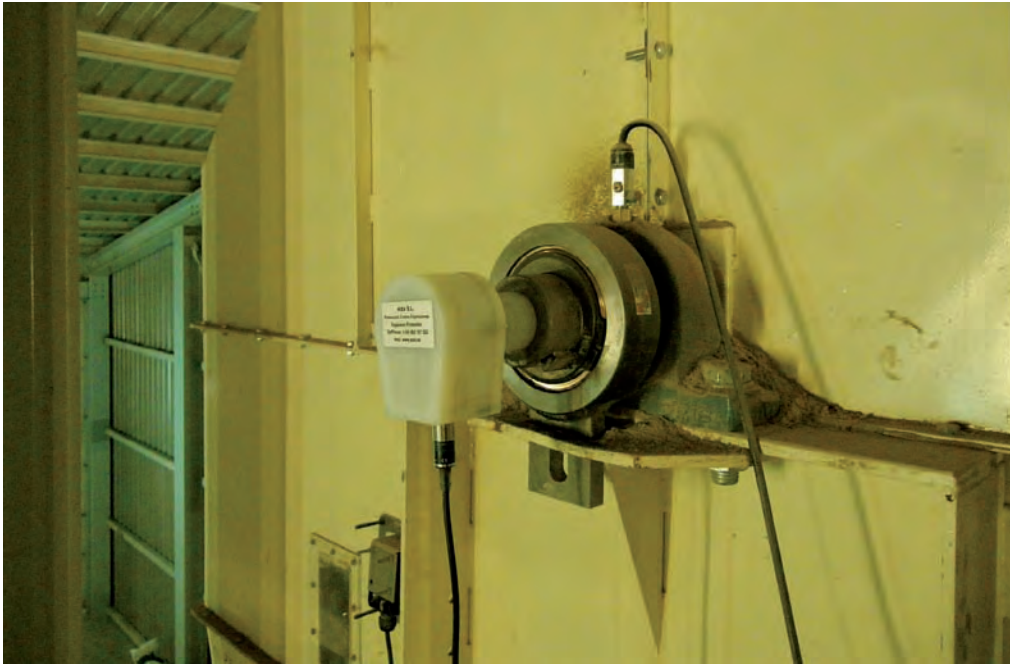
ILUSTRACIÓN 11. Control de giro en elevador de cangilones (Por cortesía de Skretting)
