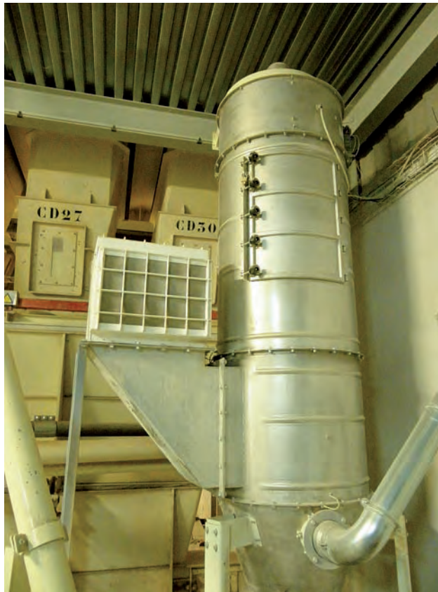
ILUSTRACIÓN 22. Montaje de venteo sin llama en filtro de mangas (Por cortesía de Skretting.)
