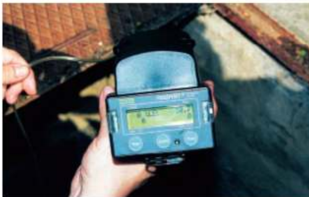
Figura 4. Medición simultánea del Índice de Explosividad y de los contenidos de oxígeno, monóxido de carbono y sulfuro de hidrógeno.
