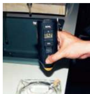
Figuras 5 y 6. Medición con tubo detector específico cuantitativo para amoníaco. Medición con detector continuo de CO 2 , con alarma óptica y acústica.
