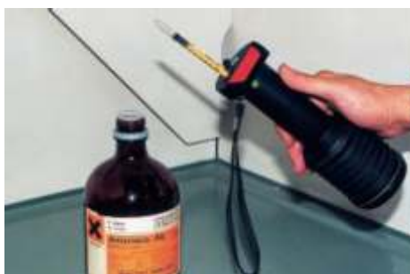
Figuras 5 y 6. Medición con tubo detector específico cuantitativo para amoníaco. Medición con detector continuo de CO 2 , con alarma óptica y acústica.
