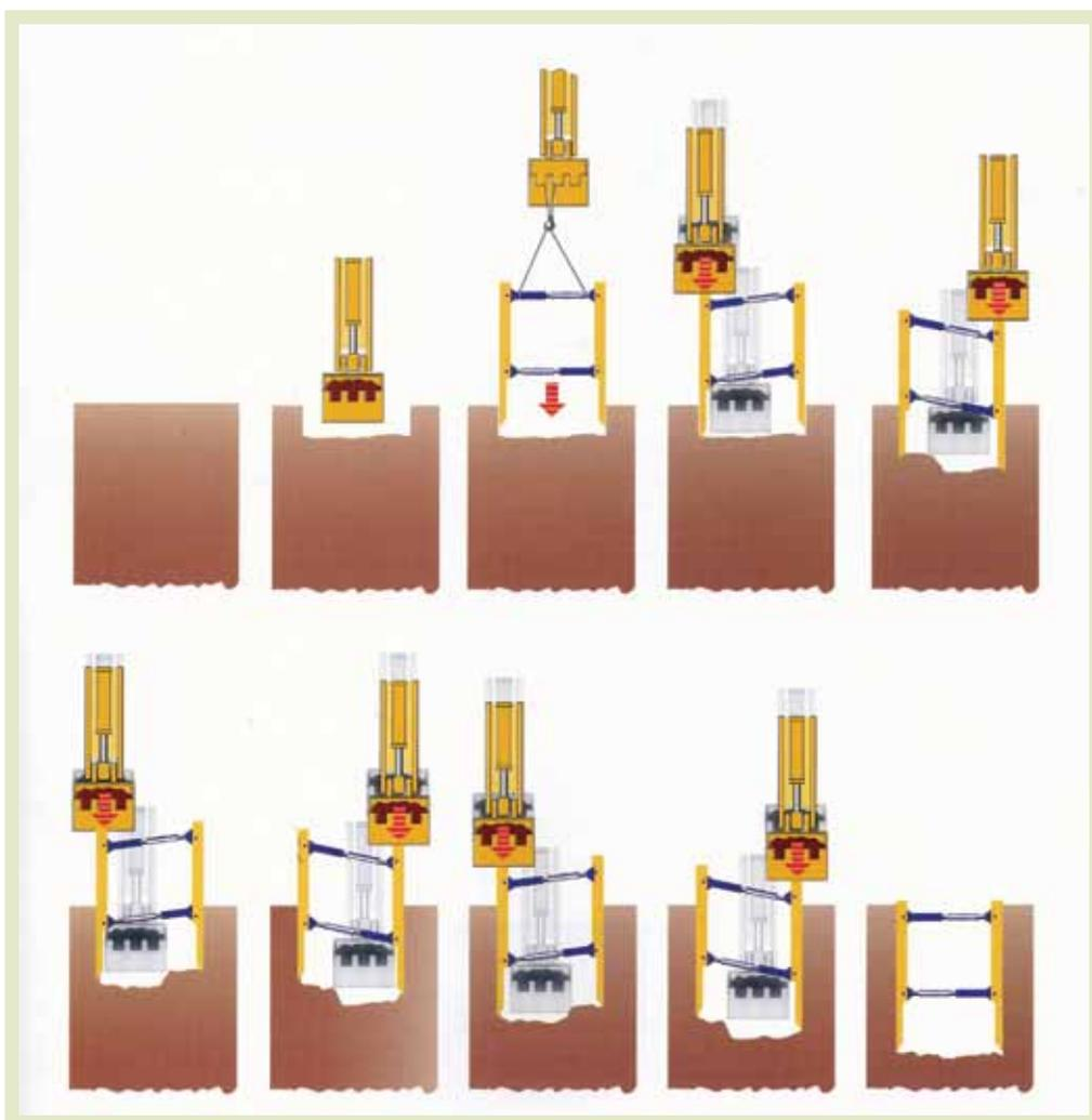
El método de descenso escalonado consiste en presionar las planchas a uno y otro lado de la entibación, alternando el descenso con la excavación y retirada del suelo. El avance en el descenso no debe exceder 0,50m del borde inferior de la plancha.
