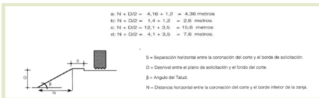
Para evitar los efectos perjudiciales producidos por pequeños desprendimientos en el caso de cortes ataluzados del terreno con ángulo entre 60° y 90° que no se entiben, a medida que se realicen se diseñarán para cada altura admisible de la siguiente tabla, mediante bermas escalonadas, con mesetas no menores de 0,65 m. y contramesetas no mayores de 1,30 m.
