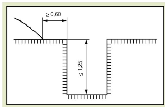
Según dichas Normas de ámbito europeo también es aceptable la ejecución de corte vertical sin entibar de hasta 1,75 m., si existe un talud superior de 0,50 m. de altura y ángulo de 45°.
