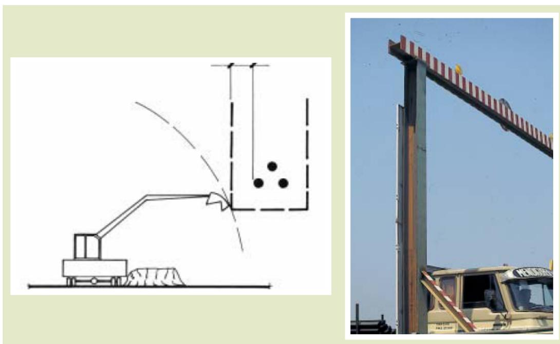
Las barreras de protección son construcciones formadas generalmente por soportes colocados verticalmente con sus pies empotrados en el suelo, arriostros por medios de cables y unidos por largueros, tablas o cables tensos para impedir el acceso a la zona peligrosa.
