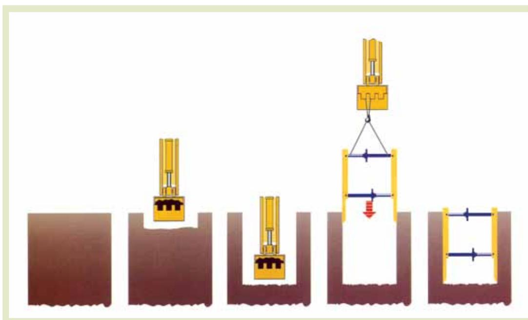
El método de descenso directo consiste en introducir la entibación en la zanja previamente excavada, hasta el fondo.
