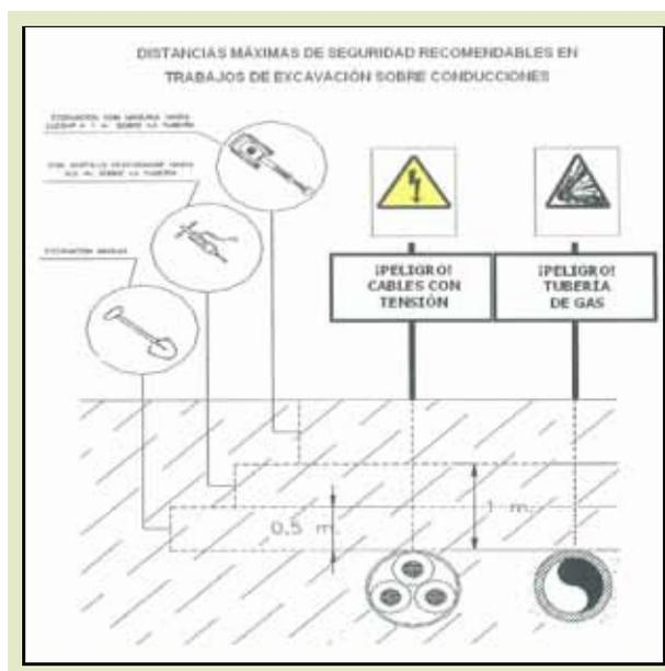
La proximidad de conducciones de gases hace recomendable la comprobación de las condiciones de higiene industrial. A tal efecto debemos señalar el accidente donde dos jóvenes fallecieron asfixiados, en el interior de una zanja de dos metros de profundidad, cuando revisaban una tubería de gas.
