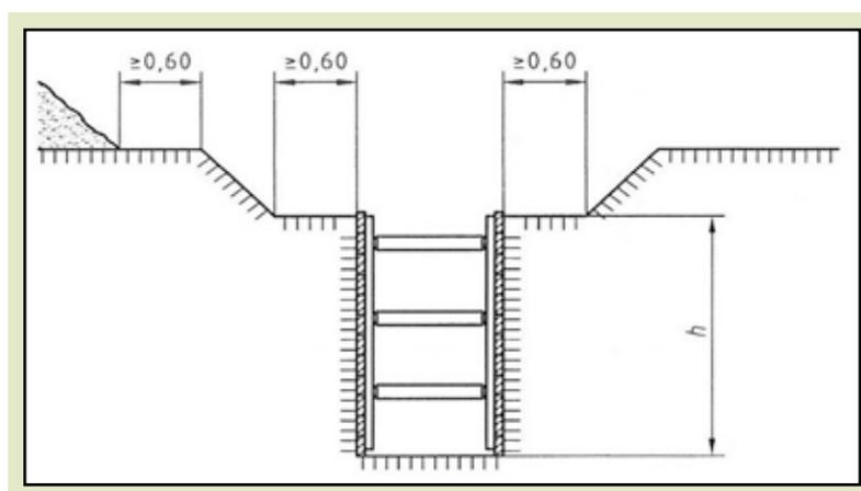
Existe la posibilidad de reducir la altura de la entibación ( $h$ ) haciendo bermas en talud, las cuales deben tener 0,60 m. de anchura mínima. Veamos una zanja entibada con excavación previa, bermas y taludes.
