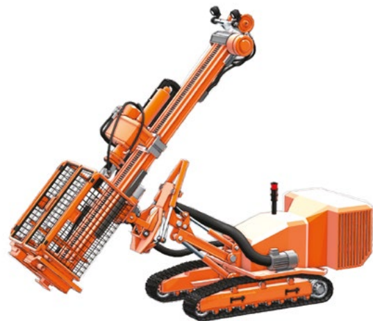
■ Figure 16. Machine automotrice de forage multidirectionnel
