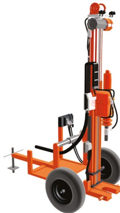
b. Avec mât de forage monté sur châssis mobile
