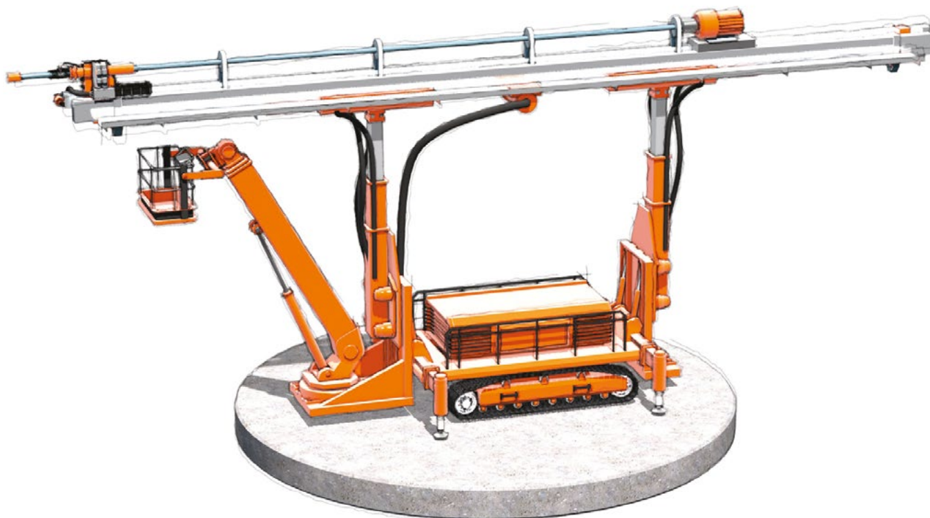
■ Figure 18. Machine de présoutènement souterrain
