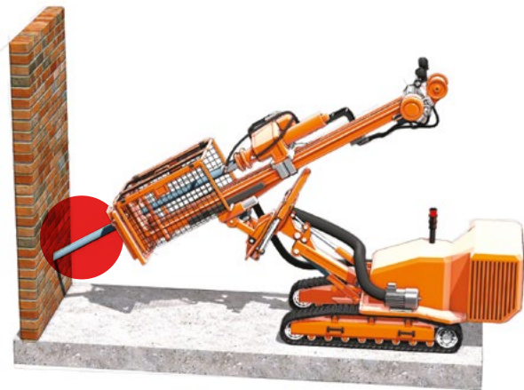
Figure 25. Éléments mobiles situés hors gabarit de la machine
