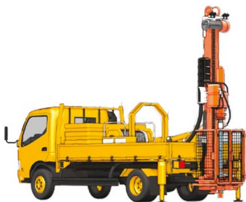
■ Figure 17. Machine de forage montée sur porteur mobile
