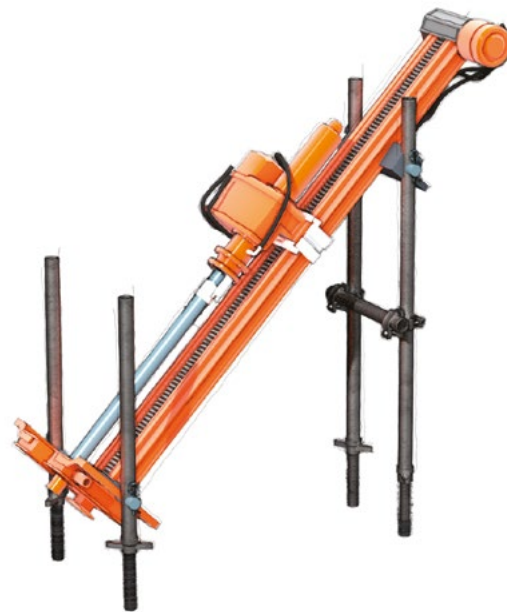
a. Avec mât de forage monté sur châssis fixe
