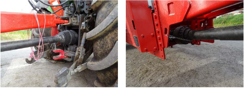
Foto 24 Elementos de protección del cardán
