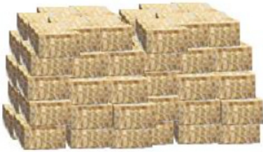
Apilamiento inestable con falta de verticalidad y estabilidad. Alto riesgo de caída y desplome.
