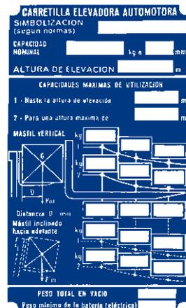
En el puesto del operador se incluirá una **placa adicional con la capacidad de carga y las limitaciones de uso** para cada conjunto formado por la carretilla y cada accesorio o implemento, que normalmente se le suele acoplar según el trabajo que realice. Todo ello se realizará de acuerdo con las instrucciones recibidas de los respectivos fabricantes. En su defecto se podría consultar con la Asociación Española de Manutención (FEM/AEM).
