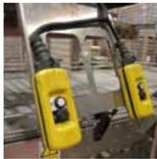
*Doble mando instalado en máquina de despaletizado*
