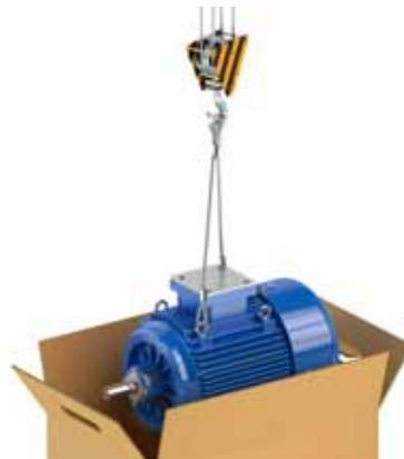
Elevación mediante accesorio de elevación
