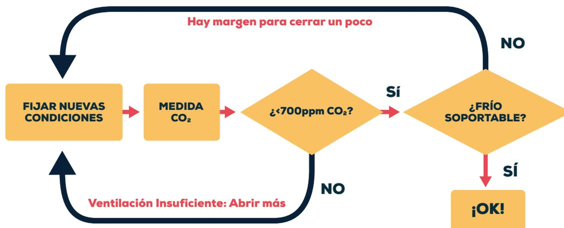
Figura 19. Diagrama de protocolo de evaluación de condiciones de ventilación.
