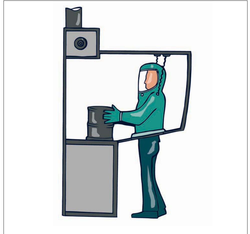
Figura 2.3.b. Sistemas cerrados: cabina de medio traje.
