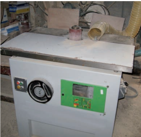
Foto 49: tupí transformada en pulidora. Es una modificación que hace que sea considerada como maquinaria nueva y necesitará un re-marcado.
