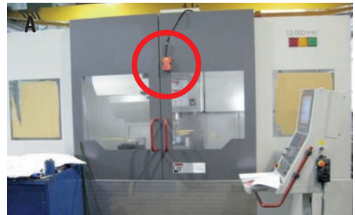
Foto 34 A y B: resguardo móvil con enclavamiento y bloqueo. El bloqueo manual no se puede considerar como tal.
