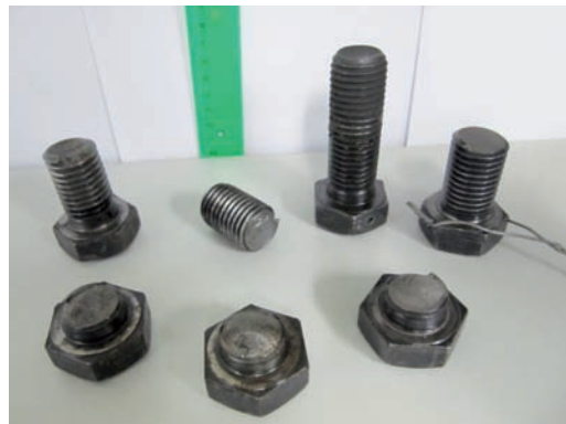
Fotos 10: Rotura en servicio de varios tornillos en una máquina por una falta de mantenimiento o un mantenimiento inadecuado.
