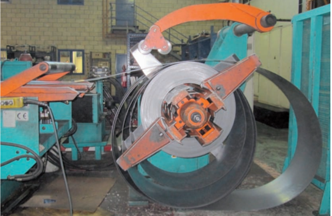
Foto 17: ejemplo de cuasi-máquina (alimentador) acoplada a una máquina sin resguardos con el riesgo de atrapamiento que representa.
