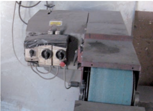
Foto 47: lijadora de fabricación propia, tendrá que cumplir el Real Decreto de máquinas.
