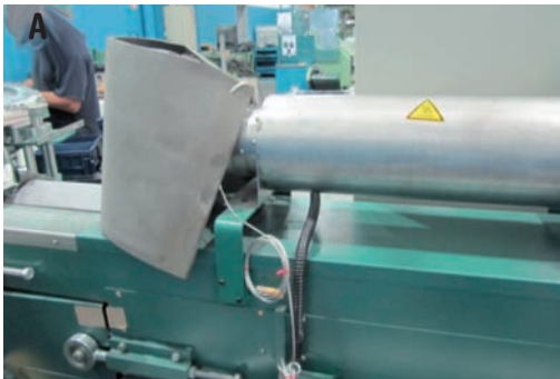
Fotos 42 A y B: si quema, una pegatina y un plástico sujeto con bridas no es la mejor protección, y poner madera debajo puede ser una mala idea por el peligro de incendio que implica.
