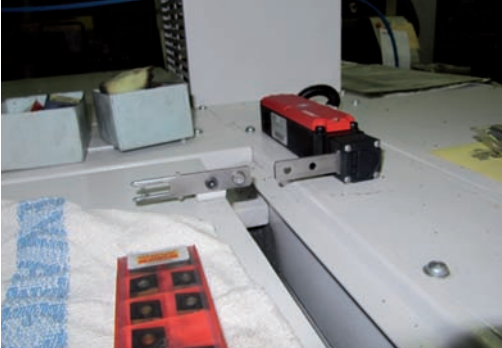
Foto 24: máquina con dispositivo del resguardo frontal puentado y el macho original del micro girado.
