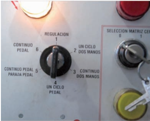
Foto 3: selector de modo no adecuado, ya que, el trabajador no puede distinguir qué modo está activo.
