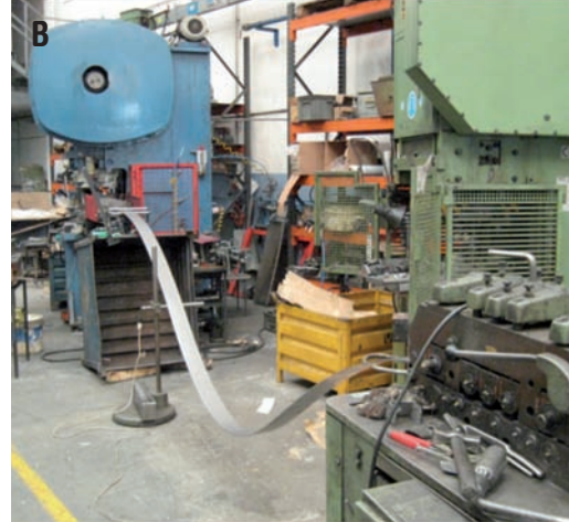
Fotos 15 A y B: como se puede ver en la foto general (izquierda) y en la local, aparte de tener un riesgo en el taller por la pletina metálica libre que impide el paso hacia una de las máquinas.
