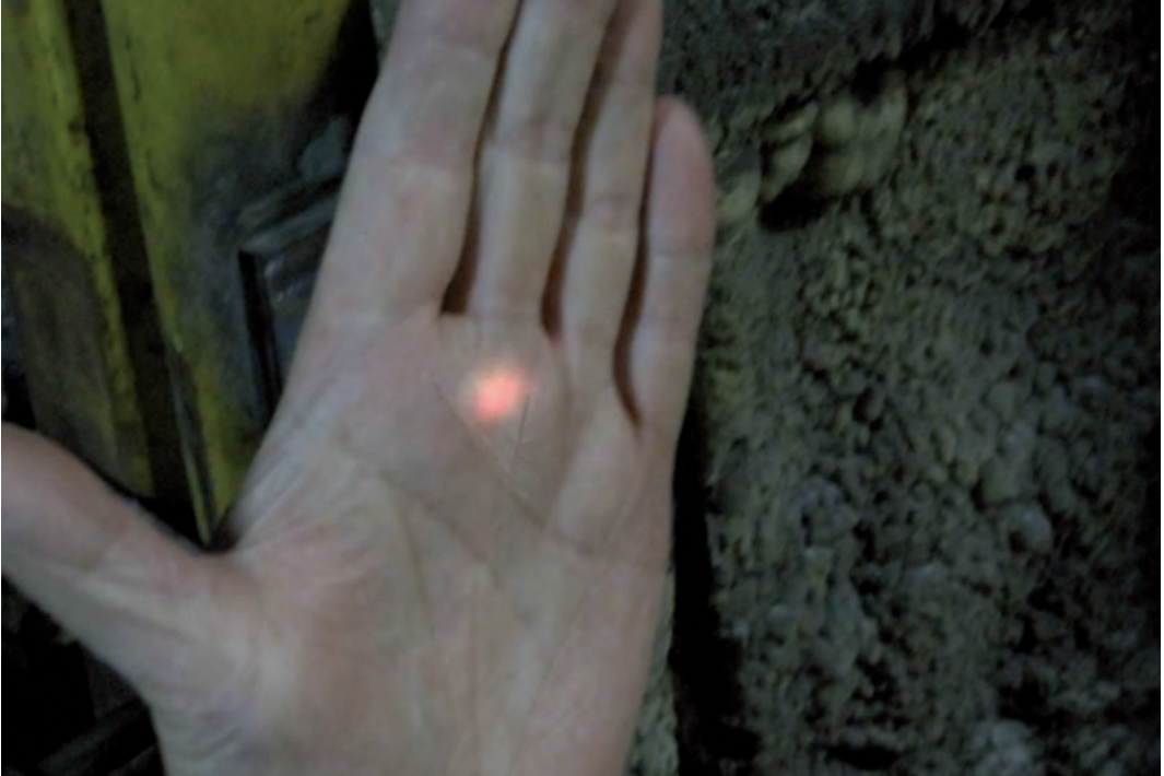
Foto 7: se ve sobre la mano el punto rojo del sensor, si el trabajador de mantenimiento interrumpe el haz la máquina realizará la función que tenga programada, con el riesgo consiguiente, a no ser que haya sido consignada.
