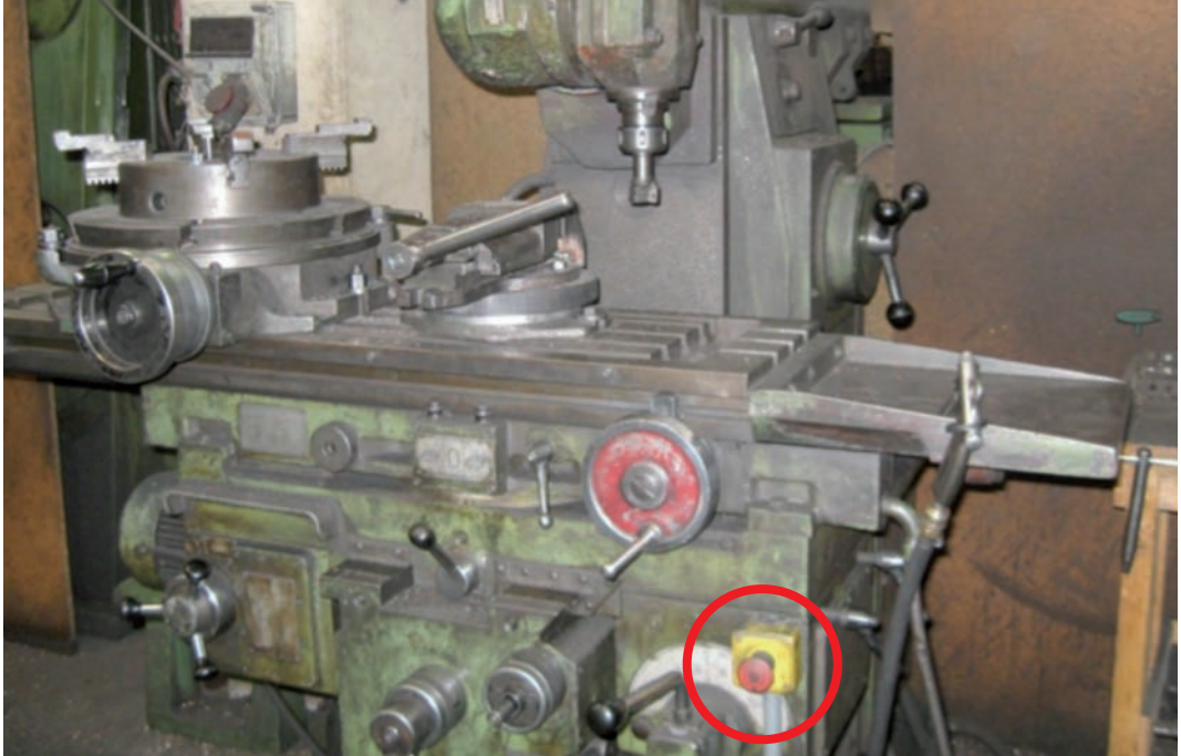
Foto 9: la máquina es anterior a 1995 y la parada de emergencia ha sido instalada en épocas más recientes, pero una adecuación no termina en la parada de emergencia.
