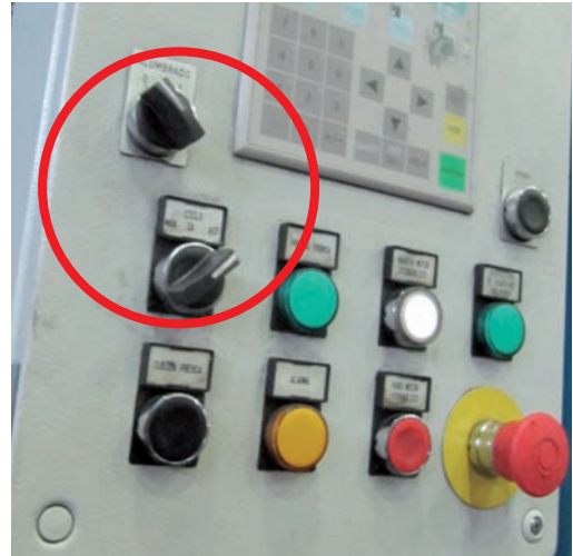
Foto 2: cuadro de mandos de una máquina, no ergonómico, ya que hay dos mandos iguales que se operan de la misma forma y están juntos aunque hacen funciones diferentes, lo que puede dar lugar a errores.
