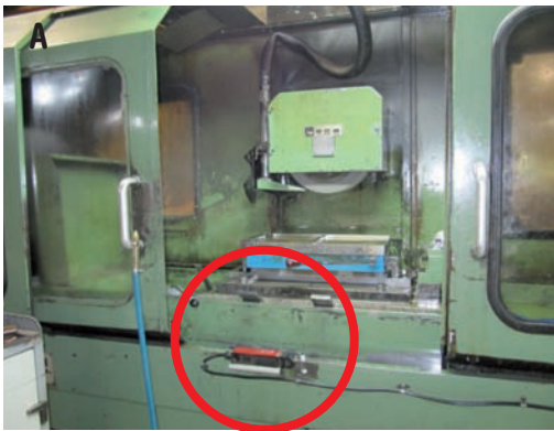
Foto 23 A y B: máquina con dispositivo puenteado y detalle.
