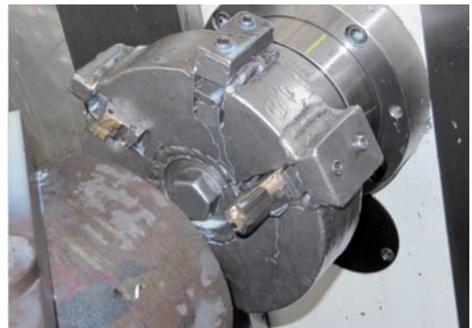
Foto 13: se ve otro plato cuyas garras han sido también modificadas y donde el riesgo de proyección de la pieza o de rotura del propio plato se ha aumentado, por no usar un plato de dimensiones adecuadas a las piezas que se desea trabajar.
