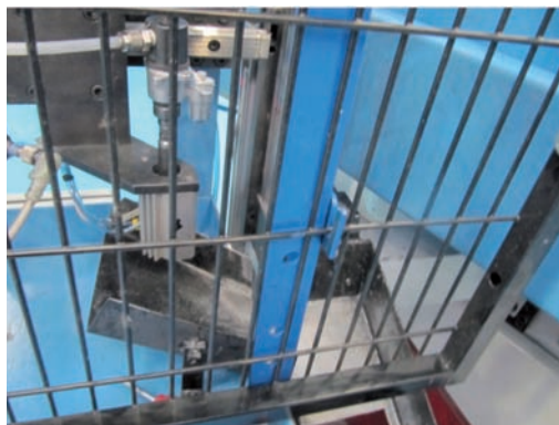
Foto 33: un resguardo fijo que se puede retirar con la mano no es fijo.
