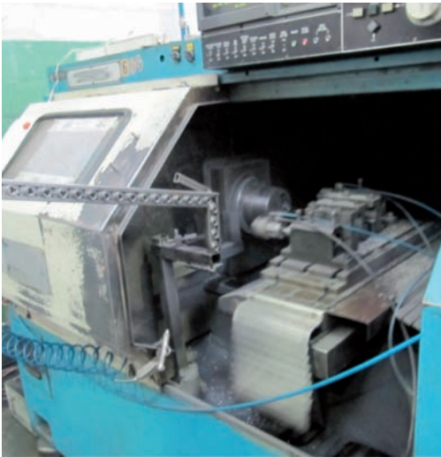
Foto 16: máquina con el resguardo retirado para instalar un alimentador, que además es de fabricación propia.
