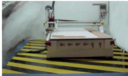
Foto 43 A, B y C: aunque en el manual se indique que para prevenir accidentes debe marcar el suelo una línea amarilla, es mejor tener activos los sistemas de seguridad de la máquina. La señalización sola no protege al trabajador frente a los riesgos de la máquina.
