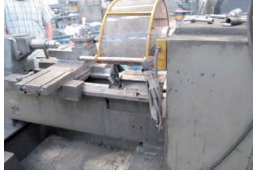
Foto 25: resguardo móvil al que se le han cortado los cables de control.
