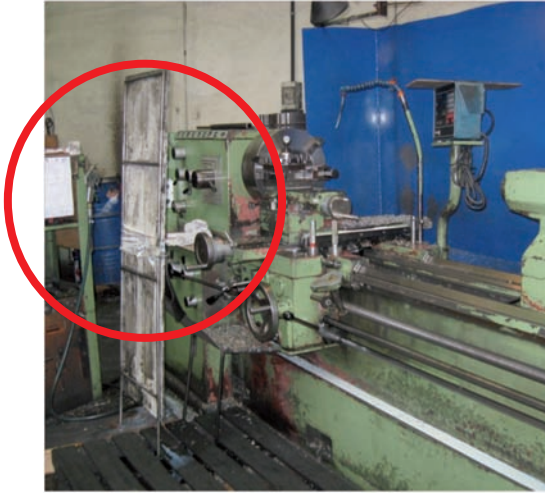
Foto 30: los resguardos para máquinas están bajo marcado, el biombo de la foto no, ni se puede considerar como un resguardo válido contra proyecciones o para impedir alcanzar partes móviles.
