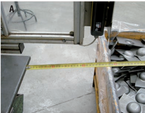
Fotos 31 A y B: las distancias a la que se sitúan los sistemas de protección tendrían que ser conformes a las normas concretas para cada máquina y/o tipo de protección. Compruébelas. Si el dedo pasa por donde no debería, revíselo, quizás no sea correcta.
