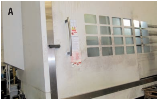
Foto 34 A y B: resguardo móvil con enclavamiento y bloqueo. El bloqueo manual no se puede considerar como tal.
