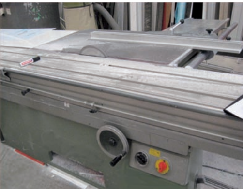
Fotos 18: escuadradora a la que se le ha retirado la protección de la hoja de sierra.
