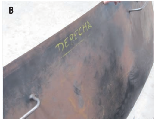
Fotos 29 A y B: resguardos móviles dos metros de largo para una máquina que eran colocadas a modo de barandilla. Parecen chapas y lo son, no pueden considerarse resguardos de ningún tipo.
