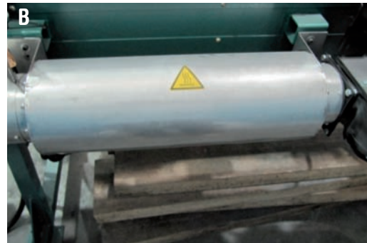
Fotos 42 A y B: si quema, una pegatina y un plástico sujeto con bridas no es la mejor protección, y poner madera debajo puede ser una mala idea por el peligro de incendio que implica.
