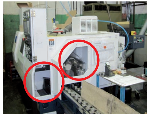
Foto 32: máquina nueva a la que han retirado varios resguardos fijos.
