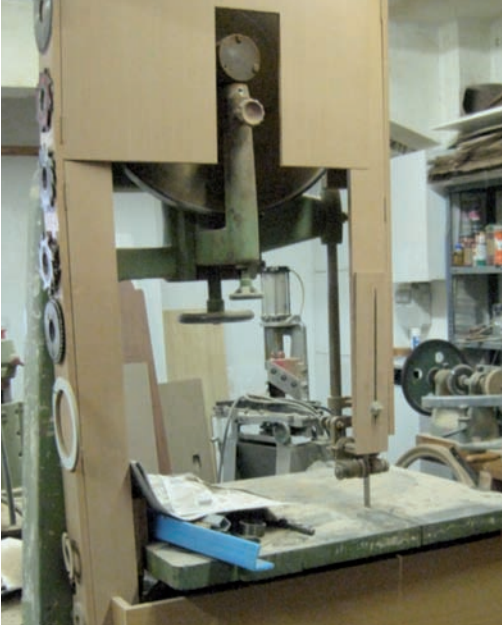
Foto 28: sierra con resguardos de fabricación propia. Los resguardos son elementos de seguridad y tienen su marcado.
