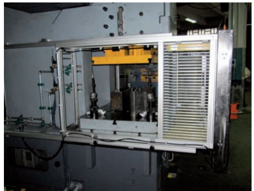
Fotos 19: prensa a la que se ha retirado el resguardo lateral y no se ha vuelto a reponer.
