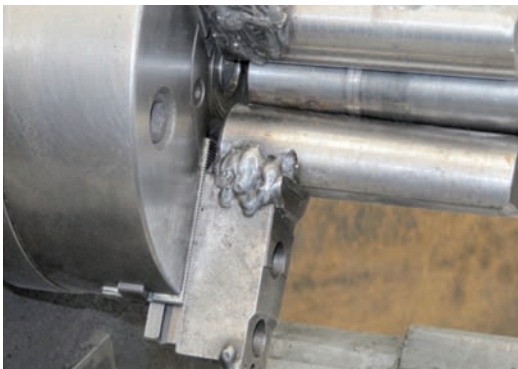
Foto 12: se ve un plato a cuyas garras se le han añadido unas extensiones para poder agarrar piezas de un tamaño diferente al que indica el fabricante en los límites de utilización, recordamos que esto modifica la máquina y crea riesgos añadidos.
