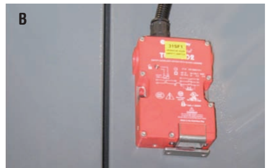
Foto 35 A y B: máquina con marcado CE con dispositivo de seguridad modificado colocado sobre el resguardo para un puentado más cómodo.
