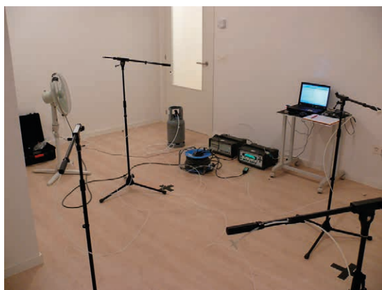
Figura 6.6. Disposición de la instrumentación durante la medida de caudales de ventilación mediante gas trazador.
