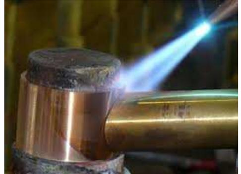
La soldadura con latón implica el empleo de un metal de relleno o una aleación (combinación de metales), con un punto de fusión más bajo que las piezas metálicas que se van a unir. Los materiales de relleno (tales como el plomo y el cadmio) pueden ser muy tóxicos.
