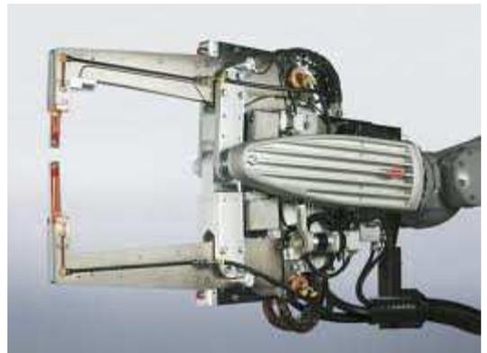
entre electrodos, que se encargan de aplicar secuencialmente la presión y la corriente correspondiente al ciclo produciendo uno o varios puntos de soldadura.
