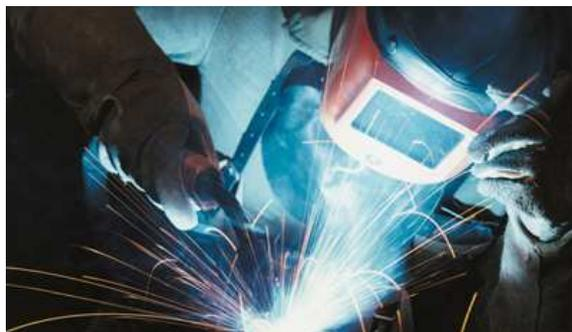
Algunos de los tipos más comunes de soldar incluyen: soldadura al arco, que incluye el soldar con electrodo (SMAW), la soldadura al arco en atmósfera de gases de blindaje (MIG), y con arco de tungsteno (TIG), la soldadura al arco con plasma, y la soldadura al arco sumergido (SAW).
