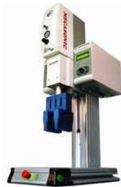
Las piezas a soldar no se calientan hasta el punto de fusión, sino que se sueldan mediante la aplicación de presión y vibraciones mecánicas de alta frecuencia.
