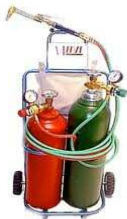
La soldadura y el corte con soplete, utilizan un gas combustible y oxígeno para producir el calor necesario (comburente). Para la soldadura con gas de alta presión, ambos, tanto el oxígeno como el gas combustible (acetileno, hidrógeno, propano, etc.) que se suministra al soplete, se almacenan en bombonas o cilindros a presión.
