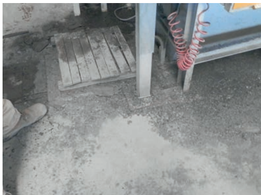
Fig. En tareas manuales que generen mucho residuo, la limpieza ha de realizarse con frecuencia. En estos casos no suele ser válida una limpieza ocasional (semanal), y a veces ni siquiera diaria. Debe introducirse el hábito de una limpieza adecuada que evite la puesta en suspensión de polvo, como parte habitual de la tarea.
