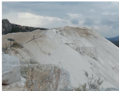
Fig. Humectación de materia prima previa a la carga y para evitar arrastre por el viento.
