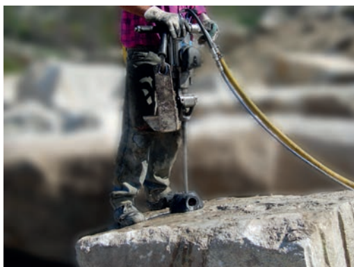
Fig. Perforación manual con uso de agua
