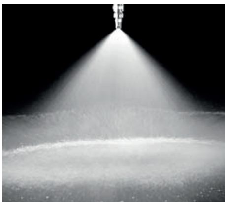
Figs. La capacidad de arrastre de la partícula de polvo en la nebulización dependerá del tamaño de gota, de ahí la importancia de seleccionar adecuadamente la boquilla.
