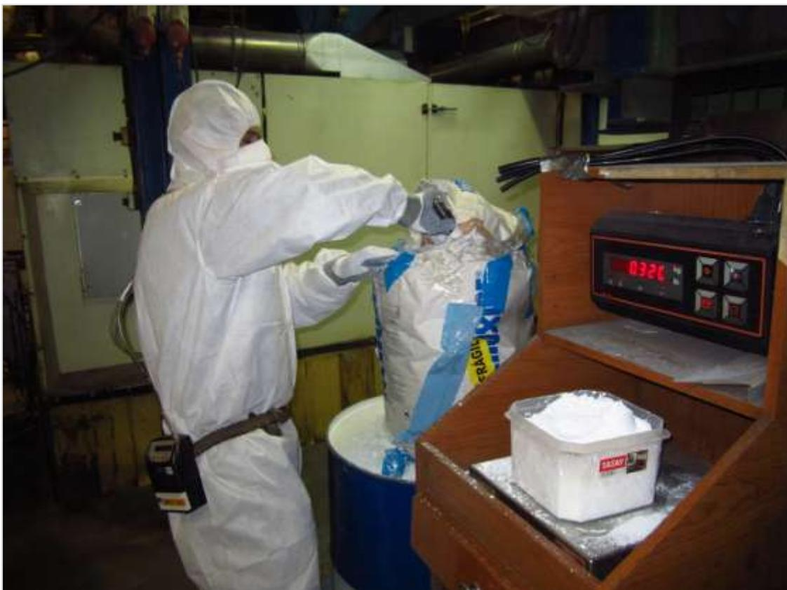
**Figura 8.1.1.- Pesaje de TiO<sub>2</sub> para la fabricación unitaria de tabletas (Operación 1, O1)**
