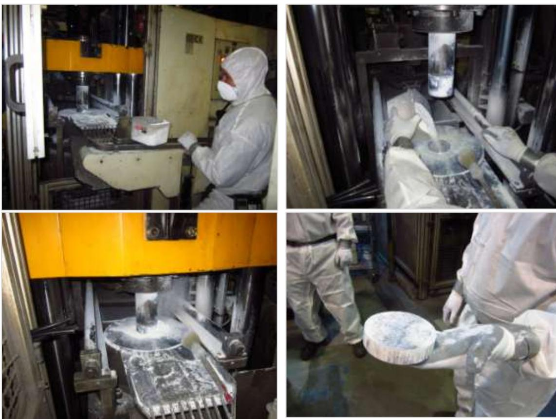
Figura 8.1.2.- Fabricación de tabletas de  $\text{TiO}_2$ . (Operación 2, O2). Detalles de la alimentación manual de nano  $\text{TiO}_2$  a la prensa de eje vertical, ciclo de prensado y tableta de nano  $\text{TiO}_2$  resultante al final del ciclo de máquina.
