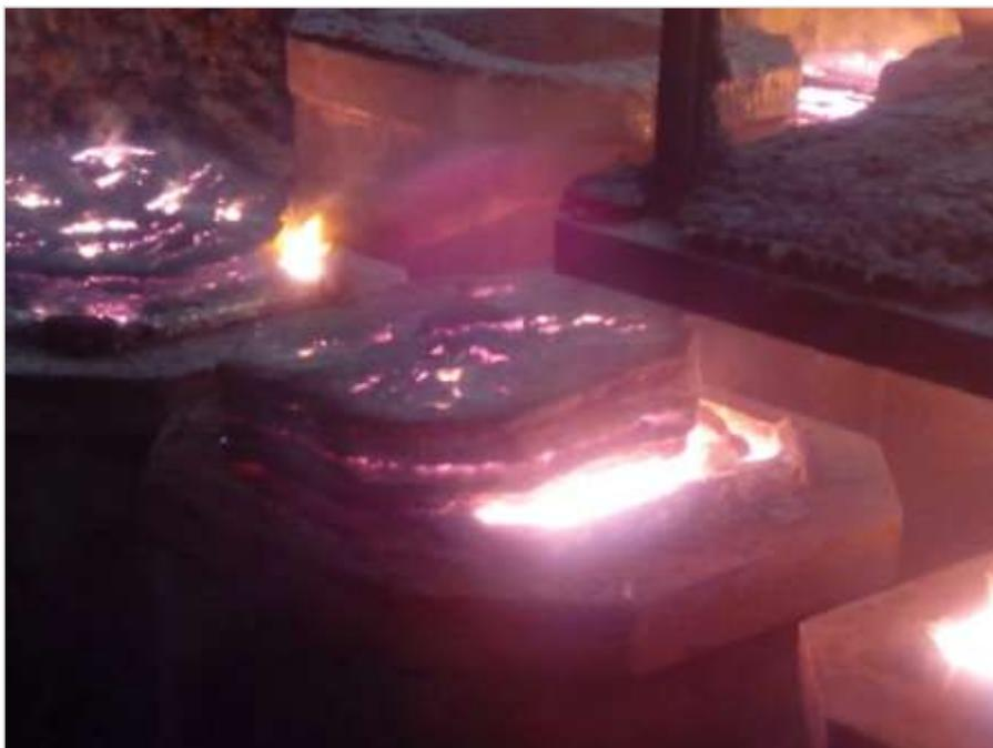
Figura 8.3.6.- Detalle de la boca de la lingotera que contenía las riostras de  $\text{TiO}_2$  una vez colado el acero.
