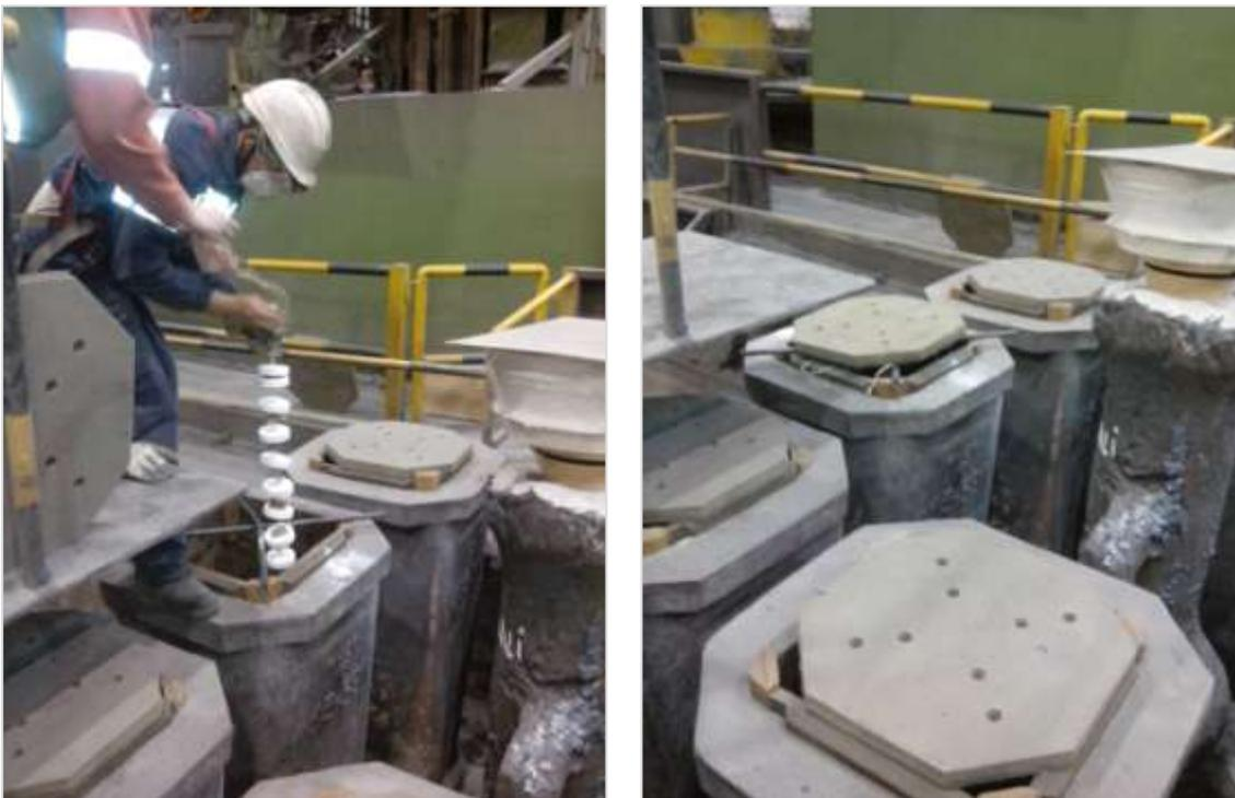
Foto 8.3.3 Detalles de la colocación de las cuatro riostras de tabletas de TiO<sub>2</sub> en el interior de la lingotera y cierre final de la boca de la lingotera con la tapa, una vez terminada la operación.
