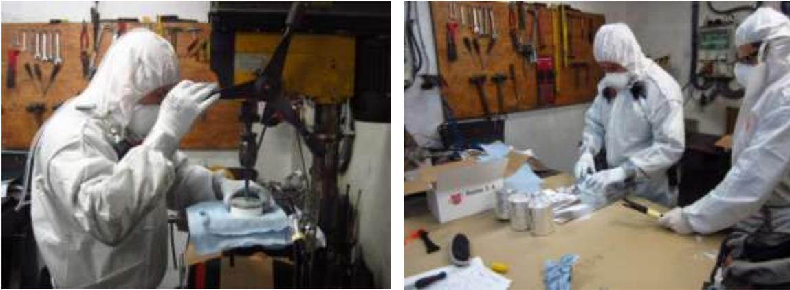
**Figura 8.1.3.- Fabricación de tabletas perforadas de TiO<sub>2</sub>. (Operación 3, O3). De izquierda a derecha, tareas de taladrado y empaquetado en grupos de cinco tabletas.**
