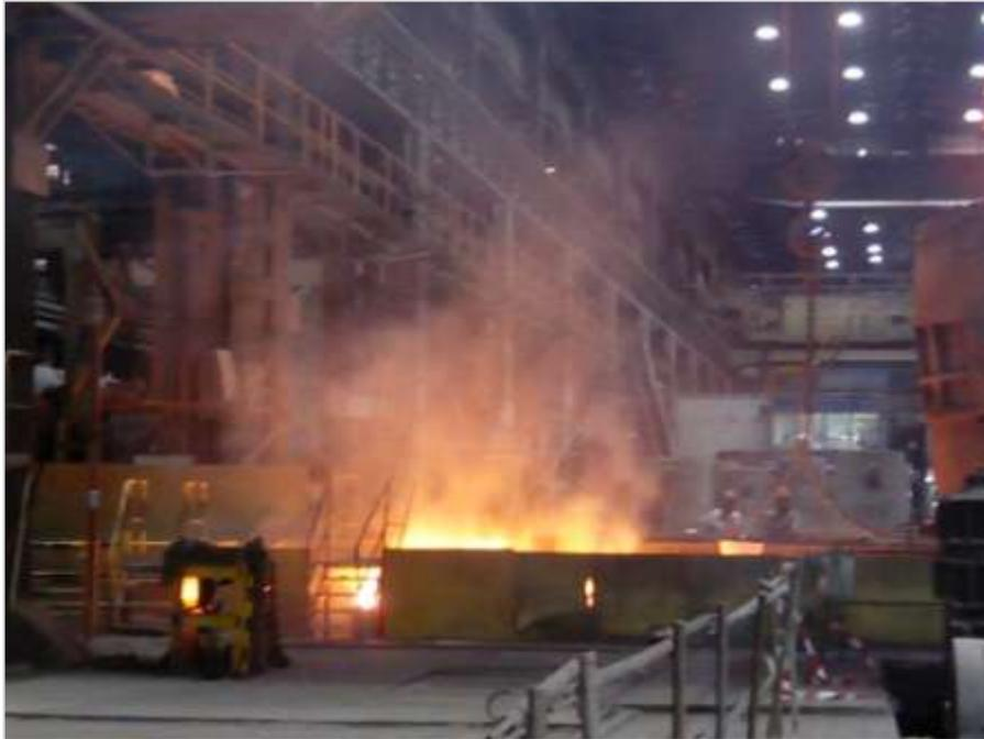
Figura 8.3.5.- Emisión fugitiva no confinada de aerosoles procedentes de las lingoteras al comienzo del ciclo de enfriamiento del acero colado. El sistema de captación de aerosoles ambientales (toma muestras + bomba) se instaló en la pasarela superior que se observa a la izquierda de la fotografía, en la vertical de la lingotera que contenía las riostras de tabletas de  $\text{TiO}_2$ , a unos 5 m de altura sobre el nivel del foso de colada.
