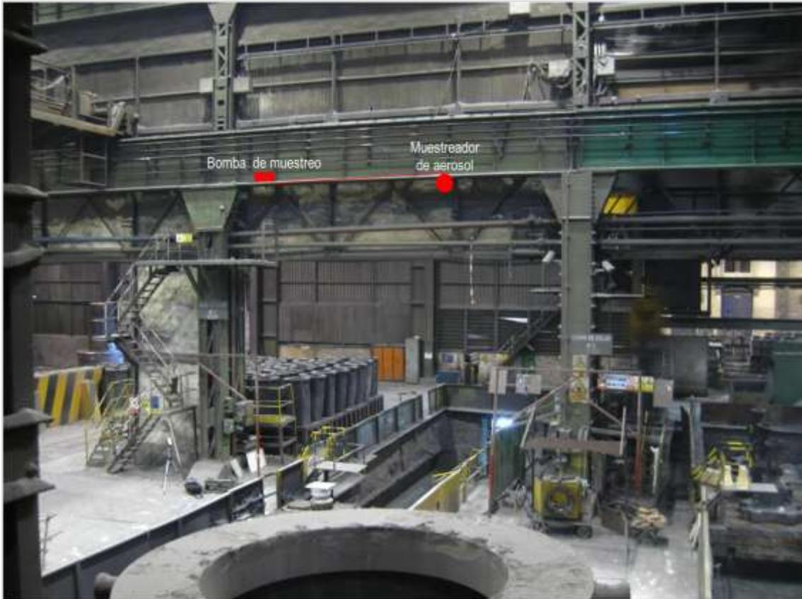
**Figura 8.3.2.-** Escenario de exposición en la acería de GERDAU Reinoso. Se observa el foso de colada donde se situarán las lingoteras y la pasarela a media altura (5 m) donde se instaló el sistema de muestreo del aerosol no confinado producido por las lingoteras.
