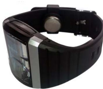
Figura 1.2. Fotografía del equipo Kronosensor de la empresa Cronobiotech y del Laboratorio de Cronobiología de la Universidad de Murcia. El dispositivo realiza las funciones de un reloj convencional y permite la medida simultánea y continua de temperatura de la piel de la muñeca, actividad motora, posición corporal y exposición a la luz. Además incorpora un marcador de eventos para el registro de los horarios de comidas.
