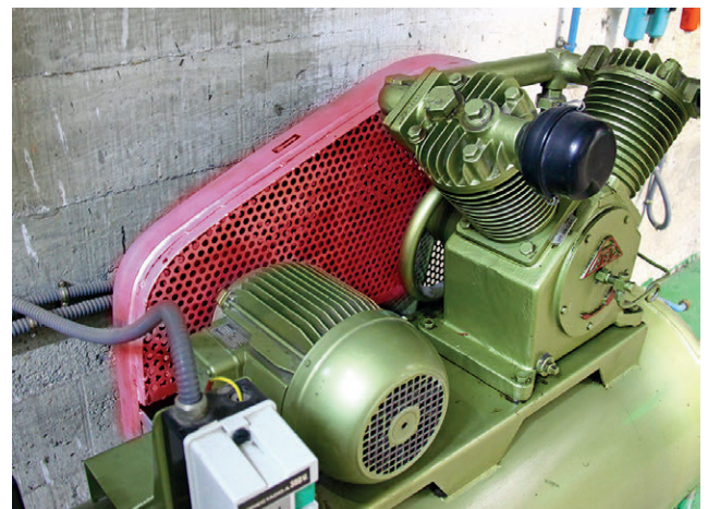
Figura 2. Resguardo fijo envolvente aislando una zona peligrosa. 72
