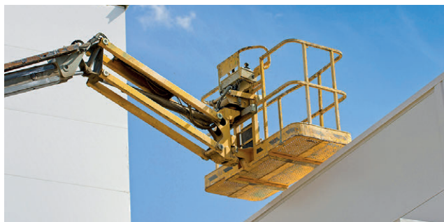
Figura 16. Habitáculo unido permanentemente al equipo de trabajo (PEMP).
