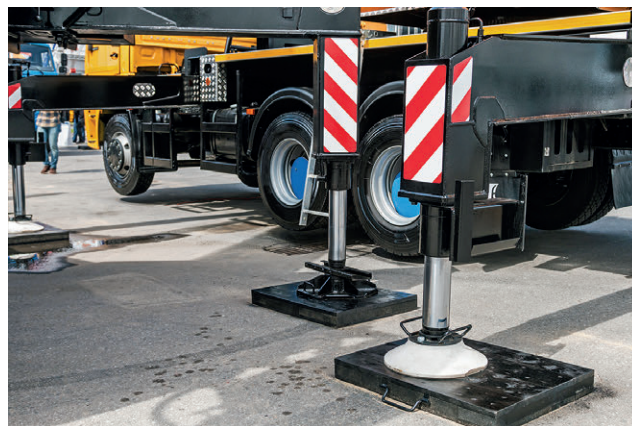
Figura 9. Ejemplo de colocación de elementos suplementarios en los apoyos de los estabilizadores de una grúa móvil.
