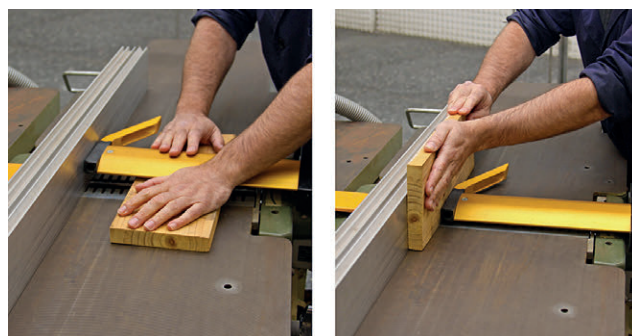
Figura 7a. Resguardo de cierre automático en una cepilladora. 77
