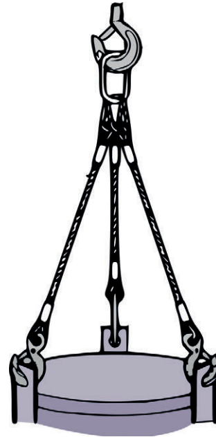
Figura 8. Los puntos de enganche al equipo de elevación y de prensión de la carga aseguran un reparto equilibrado de la carga.
