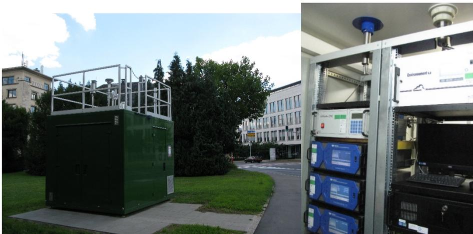
**Estación de control de la calidad del aire y puntos de muestreo (dispositivos azules en la imagen de la derecha)**
