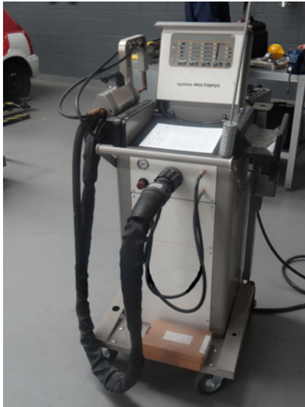
Figura 6.2. Soldador manual por puntos típico de un taller de reparación de carrocerías. El sistema es móvil con la unidad de control sobre ruedas. Los cables eléctricos y de refrigerante salen de la parte frontal de la unidad y entran en la posterior de la pistola de soldar, que se deja en su soporte a la izquierda del panel de control
