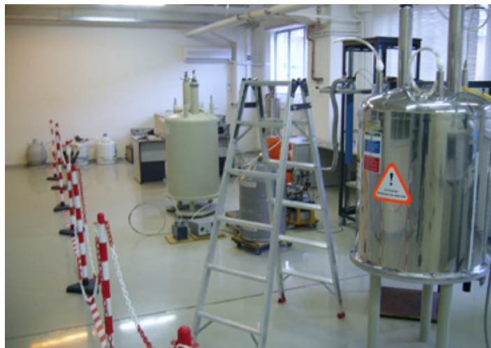
Figura 2.4. Demarcación del área restringida mediante una barrera de cadena y colocación de señales en el suelo
