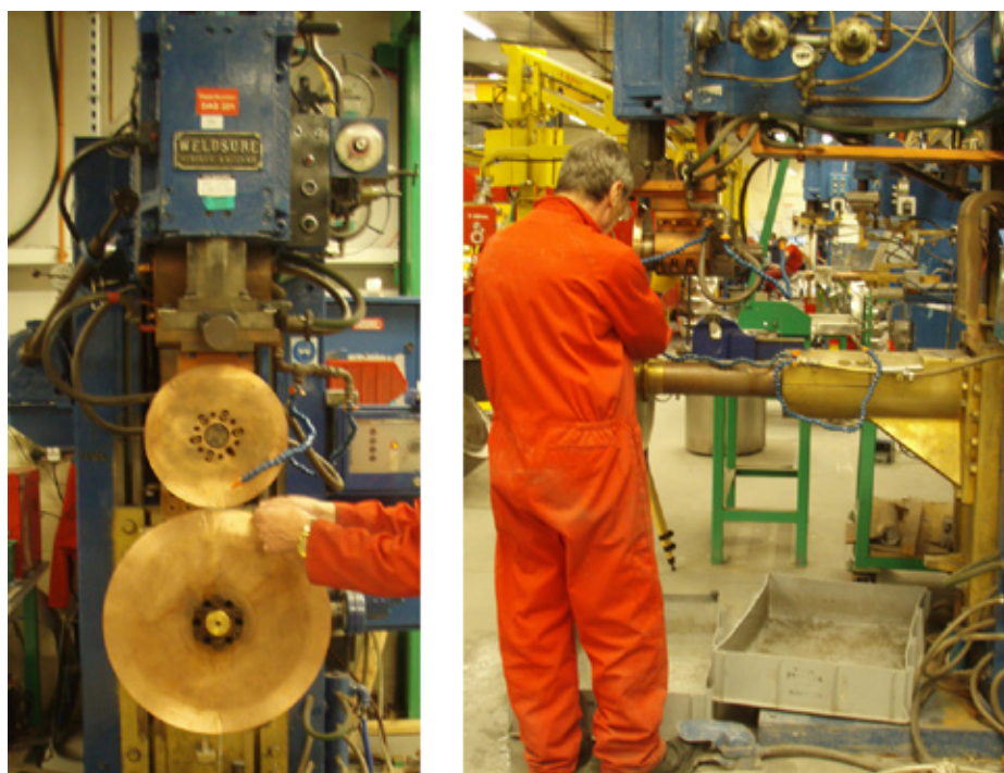
Figura 7.3. Vistas frontal y lateral del equipo de soldadura en cordón
