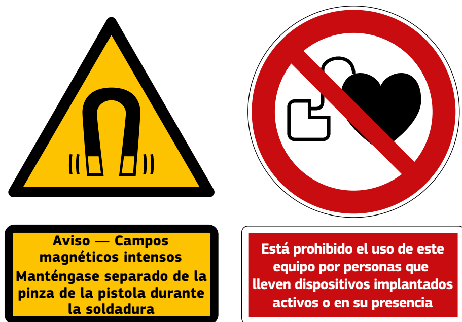
Figura 6.15. Ejemplos de señales de advertencia de campos magnéticos fuertes y de prohibición de uso del equipo de soldadura por personas que lleven DMIA, o en su presencia
