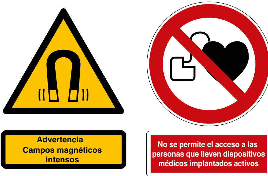
Figura 8.6. Ejemplo de señal de advertencia colocada en los puntos de acceso a las zonas de trabajo
