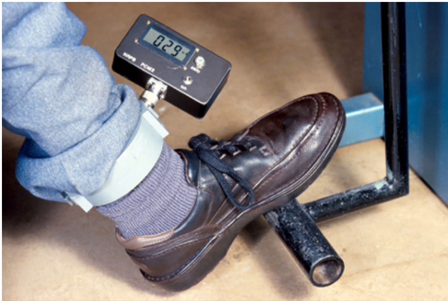
Figura C.7. Medidor de corriente de pinza empleado para medir la corriente de extremidades al utilizarse un soldador dieléctrico de 27 MHz
