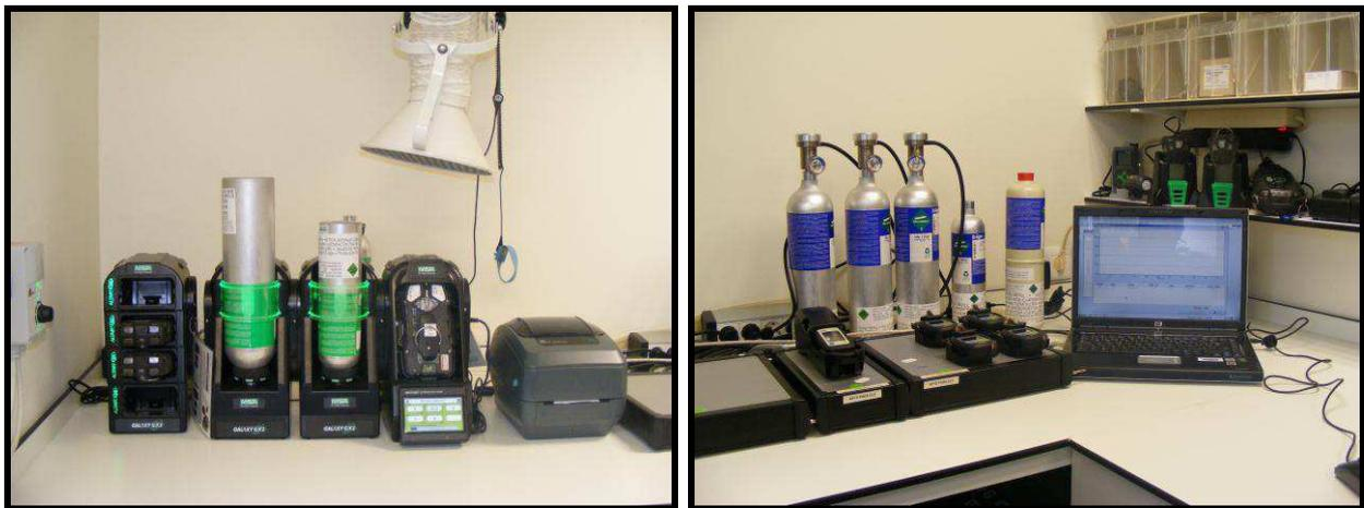
Calibración de detectores con gases patrón
