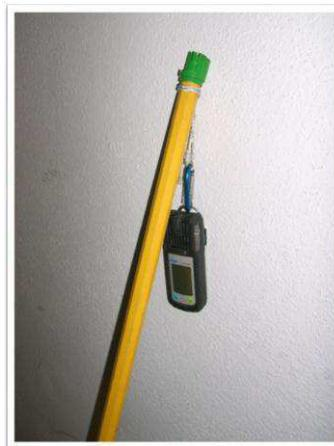
Detector de gases colocado en un palo
