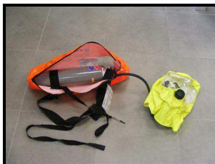
Este tipo de equipos utiliza el oxígeno almacenado en una pequeña botella de aire comprimido a alta presión, que proporciona al usuario la autonomía necesaria para realizar la evacuación de un lugar peligroso en caso de emergencia. También pueden ser utilizadas para asistir con aire de calidad respirable a un herido durante su evacuación del recinto confinado.
