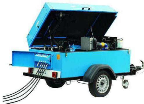
A pesar de poseer en la mayoría de los casos de un filtro para garantizar la pureza del aire proporcionado a los trabajadores, es conveniente estudiar adecuadamente el lugar de instalación de la toma de aire (lejos por ejemplo de cualquier vehículo a motor en marcha, equipos electrógenos, emanaciones de gases, etc.), para evitar la contaminación del aire que será impulsado hacia los operarios.
