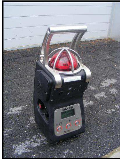
Su función es básicamente la monitorización de atmósferas en trabajos donde el operario no va a realizar desplazamientos considerables. Tras ubicarlas en el lugar de trabajo, realizarán su función sin molestar al operario. Pueden funcionar tanto instaladas dentro del recinto confinado como en el exterior mediante una sonda de la longitud adecuada. Dada su mayor autonomía y potencia, comparada con los detectores portátiles habituales, son capaces de utilizar sondas de gran longitud (hasta 45m).
