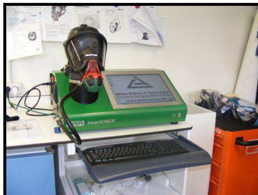
Revisión de funcionamiento y estanqueidad de la máscara de un ERA
